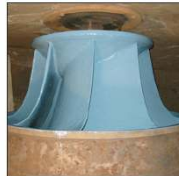
След защитното покритие с Belzona® 1341
