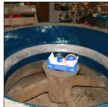
Завършеното приложение е готово за инсталиране на носещия пръстен и връщане в експлоатация
